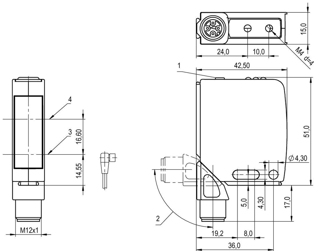
1) Панель индикации и управления, 2) Поворачивается на 270°, 3) Оптическая ось, передатчик, 4) Оптическая ось, приемник
