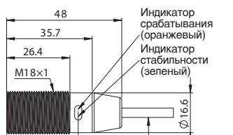
Круглый кабель в виниловой изоляции, диаметр 4 мм. Кабель имеет стандартную длину 2 метра, состоит из 4 проводников сечением 0,128 мм<sup>2</sup> (AWG26), наружный диаметр изоляции 0,85 мм.
