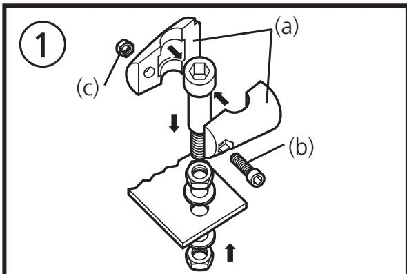
Montieren Sie die beiden Schellenhälften (a) lose mit Hilfe der beiliegenden Schraube (b) und Mutter (c).
