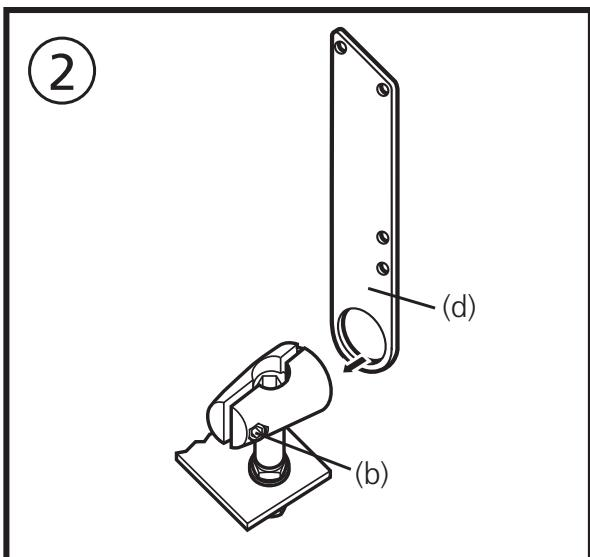
Befestigen Sie den Haltewinkel (d) und ziehen Sie anschließend die Schraube (b) soweit an, daß sich der Winkel noch drehen läßt.
