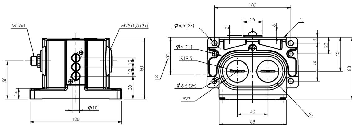
1) Опорная кромка, 2) Уплотнительное кольцо, 3) Кабельный ввод
