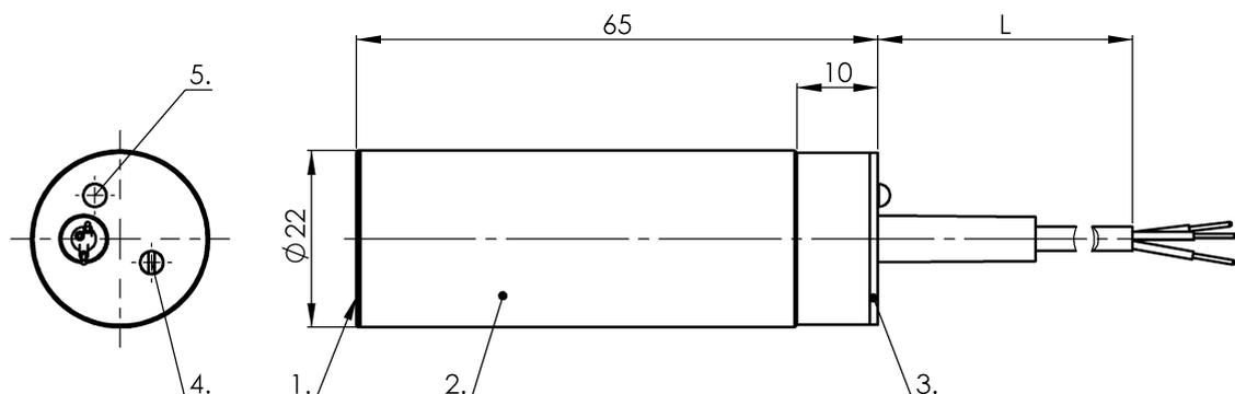
1) Активная поверхность, 2) Корпус, 3) Крышка, 4) Потенциометр, 5) Функциональный СД
