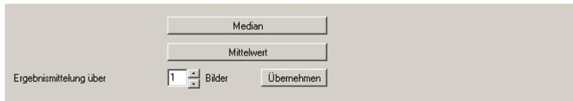
No filtros espaciais Mediano e Valor médio se utiliza a "avaliação da média 3x3". Inicialmente se considera o valor de medição do pixel a ser filtrado. Em seguida, este é relacionado com os 8 pixels adjacentes. Cada filtro calcula um valor médio dos 9 pixels, as condições de cálculo para os diferentes filtros variam neste caso.
