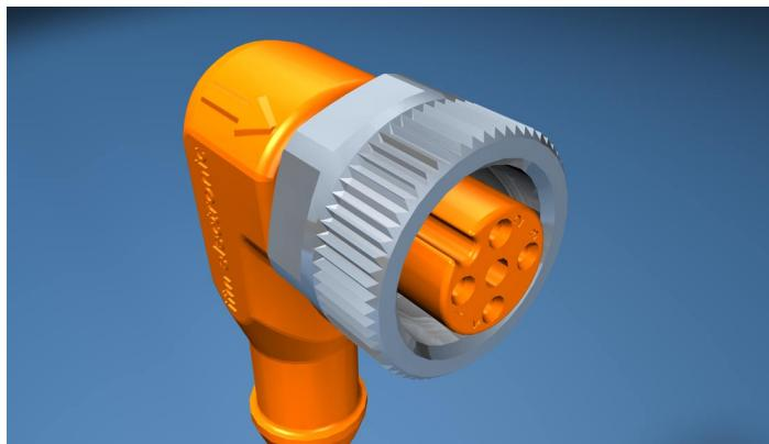
Verbinden Sie den Steckverbinder mit dem Sensor, der Pfeil zeigt die richtige Lage der Kodierung. Um die angegebene Schutzart zu gewährleisten, muss die Überwurfmutter mit einem Anzugsdrehmoment von 0,6 Nm (handfest) bis 1,5 Nm (Schlüsselmontage) angezogen werden. Bei Steckern ist das Anzugsdrehmoment des Gegenstücks zu beachten.
