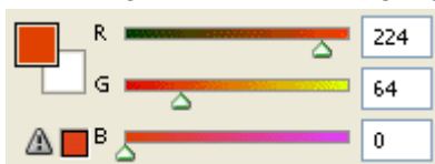
Bild: RGB-Farbmischung bei Photoshop; 100 % \Rightarrow 255 dez = FF hex
