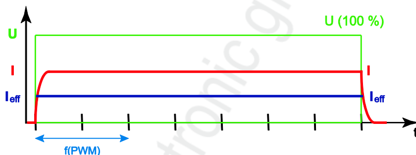
Grafik: Verlauf von PWM-Spannung U und Spulenstrom I bei 100 % Einschaltdauer: Der effektive Spulenstrom I_{\text{eff}} beträgt ebenfalls 100 %
