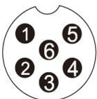
Расположение контактов штекерного разъёма (обращено к головке датчика)
