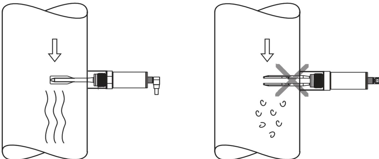
**Рисунок:** Установка VRM в трубу.
