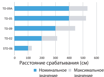
Рефлекторные датчики с поляризационным фильтром - разные рефлекторы (PSE-PM30х.../-E3)
