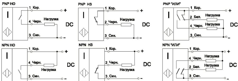
Рисунок 1 - Схемы подключения
